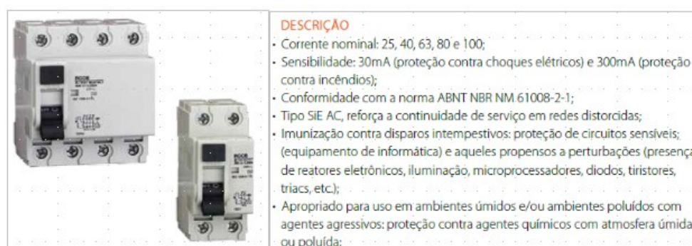
Figura 11-Descrição do Disjuntor Diferencial Residual.
